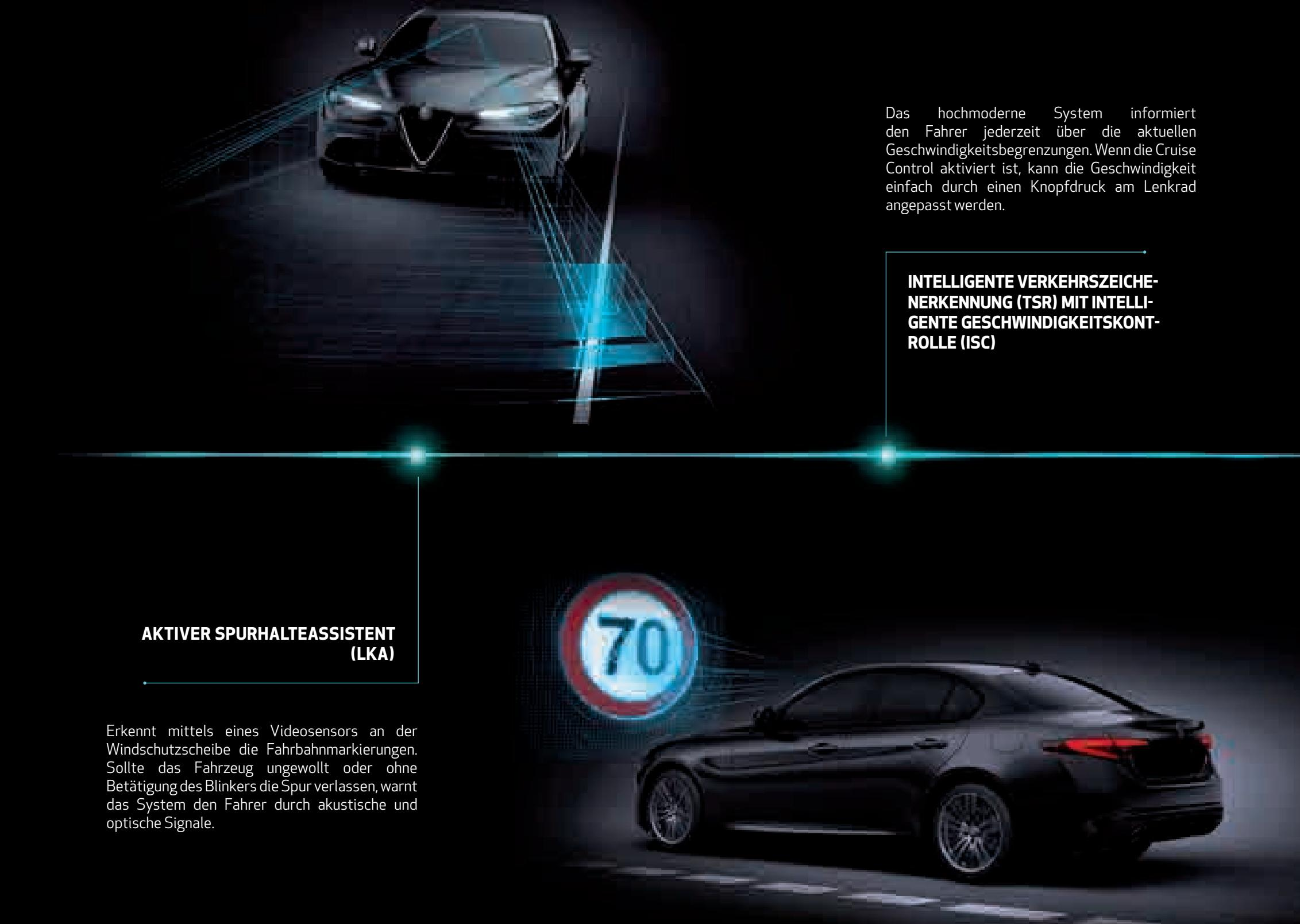
Erkennt mittels eines Videosensors an der Windschutzscheibe die Fahrbahnmarkierungen. Sollte das Fahrzeug ungewollt oder ohne Betätigung des Blinkers die Spur verlassen, warnt das System den Fahrer durch akustische und optische Signale.
